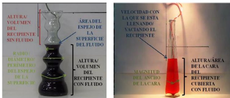
Gráfico 11 Imagen de video con ejemplos de las magnitudes que se pueden percibir durante el fenómeno de llenado o vaciado del recipiente.
