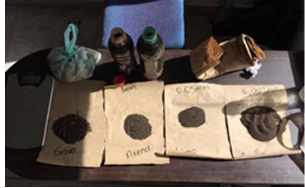
Imagen 5: Prueba de triangulo textural por tamizado, grado 9
