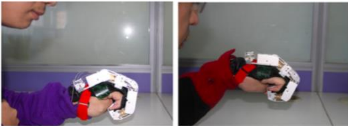
Ilustración 6. Exoesqueleto para rehabilitación de los dedos.
