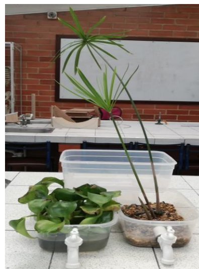
Figura 14. Humedal Artificial diseñado. (Novoa, 2018)
