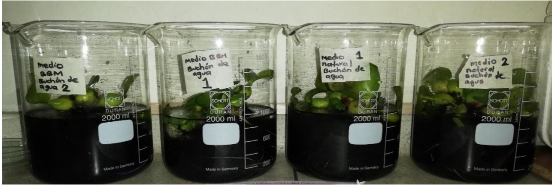
Figura 16. Medios con buchón de agua ( Eichhornia crassipes ) Al lado derecho se ubican los medios BBM, al lado izquierdo se ubican los medios naturales. (Novoa, 2018).
