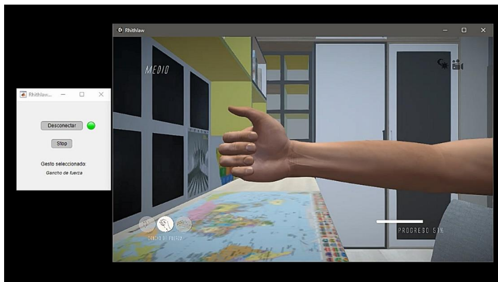
Figura 60. Respuesta de la herramienta ante una contracción muscular.
