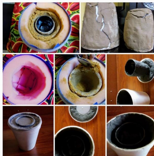
Fotografía 1. Construcción de un calorímetro (2018). Derechos de autor [2018] Alfonso , K.
