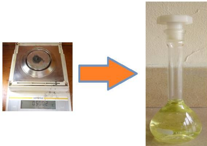
Figura 14: proceso de pesado para obtención de solución de la muestra (Lutita de Macanal)
