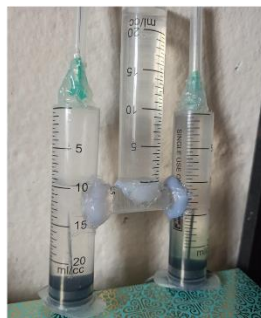
Imagen 5 y 6. Electrolisis de cloruro de magnesio con electrodos de acero
