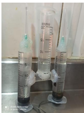
Imagen 1: simulador voltámetro de Hoffman
