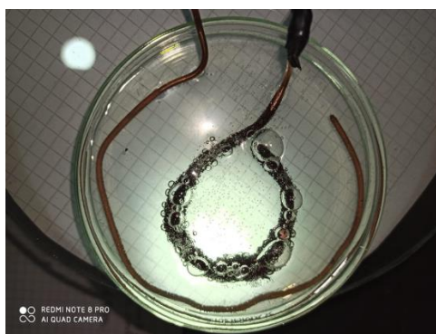
Imágenes 8- y 9. Electrólisis del cloruro de magnesio
