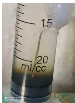
Imagen 2. Electrodo de Cobre en cada jeringa
