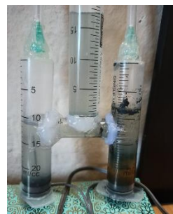
Imagen 5 y 6. Electrolisis de cloruro de magnesio con electrodos de acero
