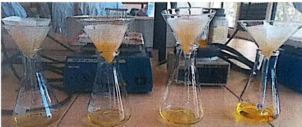
*Ilustración 44. Proceso de filtrado tras 1 hora en agitador magnético*
