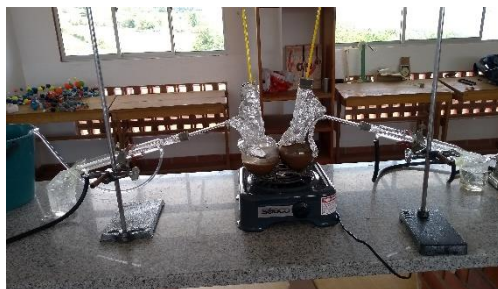
Imagen 2: Montaje para destilación de la muestra.
