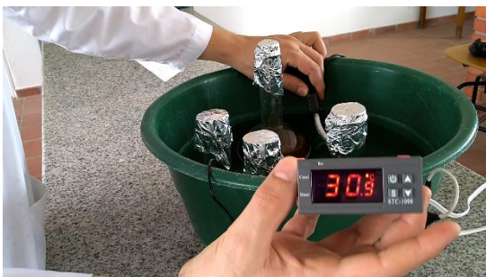
Imagen 1: Montaje de fermentación, el diseño empleado permitió mantener la temperatura constante.
