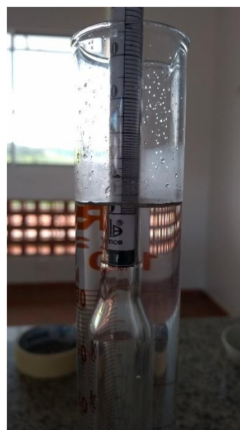
Imagen 3: Medición de etanol mediante hidrómetro. Fuente: archivo del autor
