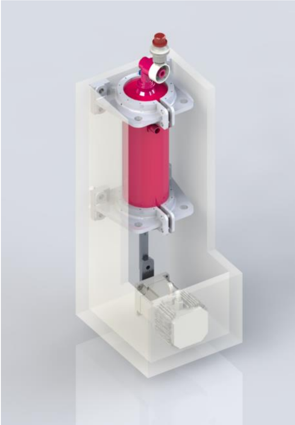
Figura 59 – Sistema con su estructura.
