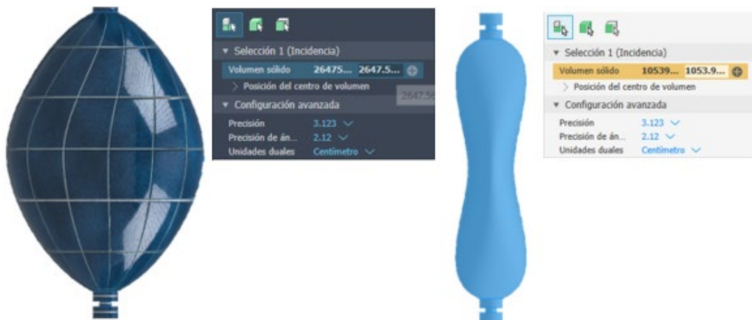
Figura 26: Volumen de la Bolsa AMBU antes y durante la compresión Tomado de: Autodesk Inventor 2020
