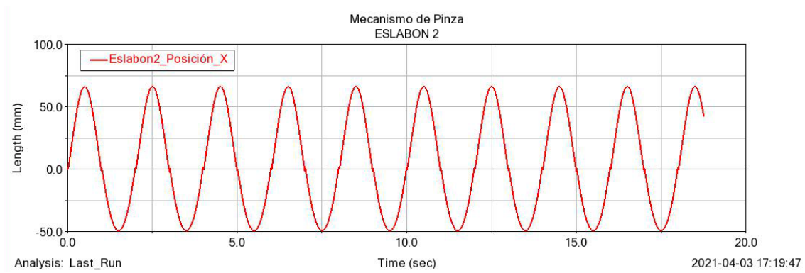
Figura 47: Posición del eslabón número 2 con respecto al eje X
