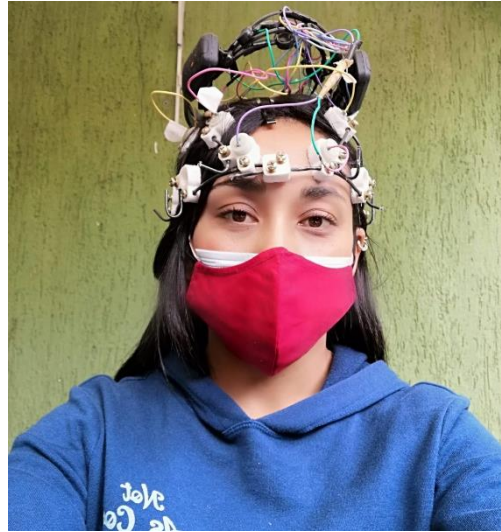
Ilustración 5. Instalación de electrodos.
