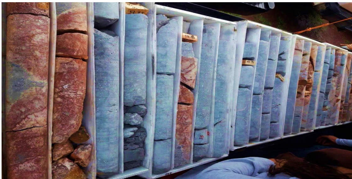
Imagen 7. Núcleos de roca analizados por el grupo de estudiantes, mediante comparación de resistencia al resquebrajamiento y fricción.
