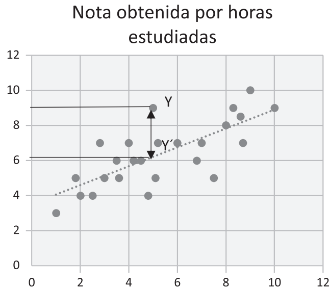
Figura 33. Diagrama de dispersión en el que se ha graficado la recta de regresión y el error (Y - Y') de una predicción específica ( Y )
