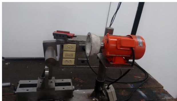
Ilustración 43 Maquina afiladora de buril
