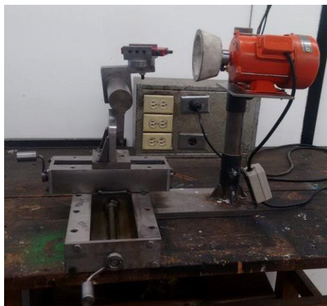
Ilustración 44 Maquina afiladora de buril
