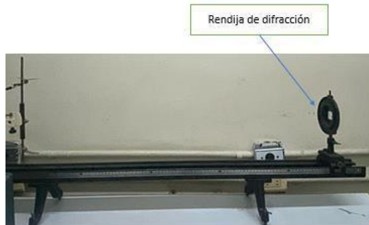
Imagen 13. Montaje rejilla de difracción (elaboración propia)
