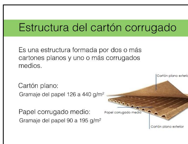
Figura 19. Estructura del cartón corrugado.
