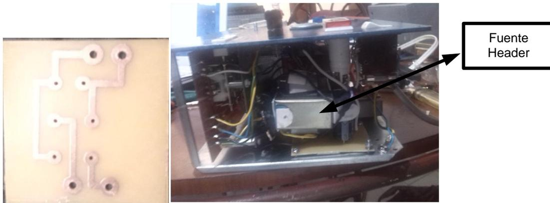
Concluida la fuente de alimentación y tomando nuevamente las medidas de voltaje y corriente de la fuente generadora, se estableció que todos ellos ya estaban dentro de los limites necesitados por la fuente para poner en funcionamiento el klystron.
