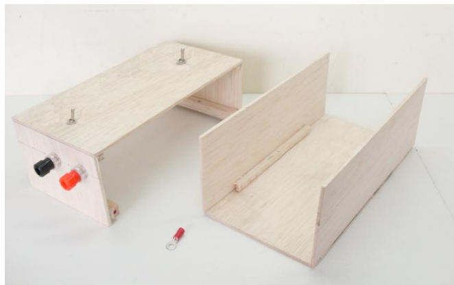
Figura 20. Prototipo de la carcasa para HAD del puente H.
