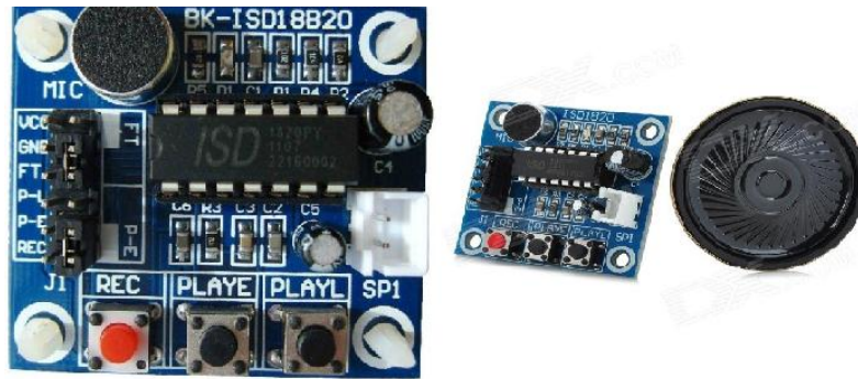
Figura 16. Tarjeta ISD 1820 grabación y reproducción de sonidos.
