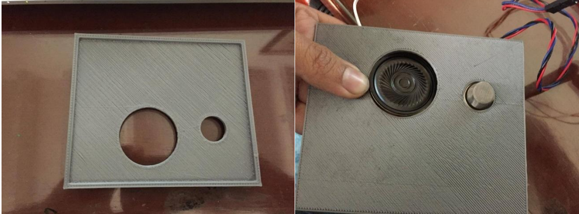
Figura 31. Impresión cara inferior y empalme con el parlante y el sensor.
