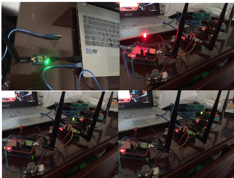
Figura 23. Secuencia de prueba comunicación inalámbrica enviando la letra “a” a través del XCTU.
