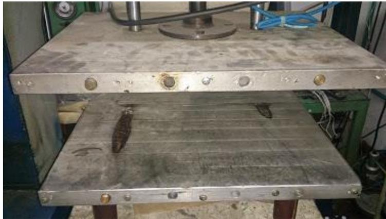
Figura 4.10: Superficies para fijar los moldes. Fuente: Propia
