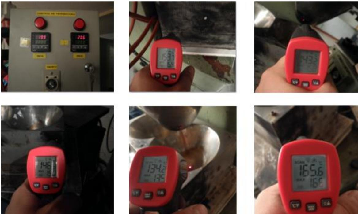
Figura 5.1: Pruebas de calentamiento con control tradicional sin modificaciones. Fuente: Propia
