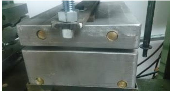
Figura 4.14: Resistencias incrustadas en los moldes. Fuente: Propia
