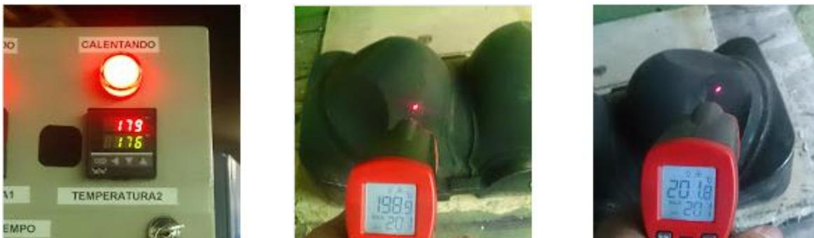
Figura 5.2: Pruebas de calentamiento con el control tradicional. Fuente: Propia
