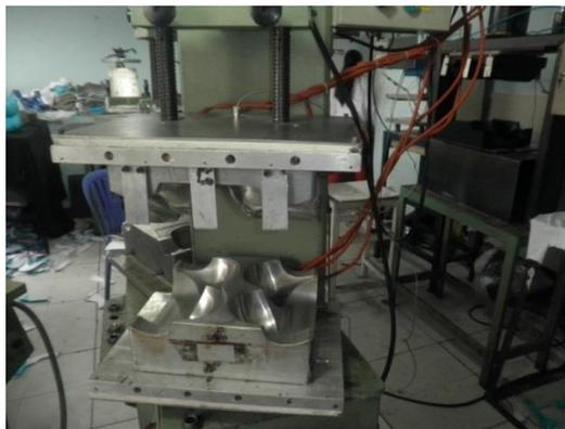
Figura 1.1: Máquina prehormadora. Fuente: Propia
