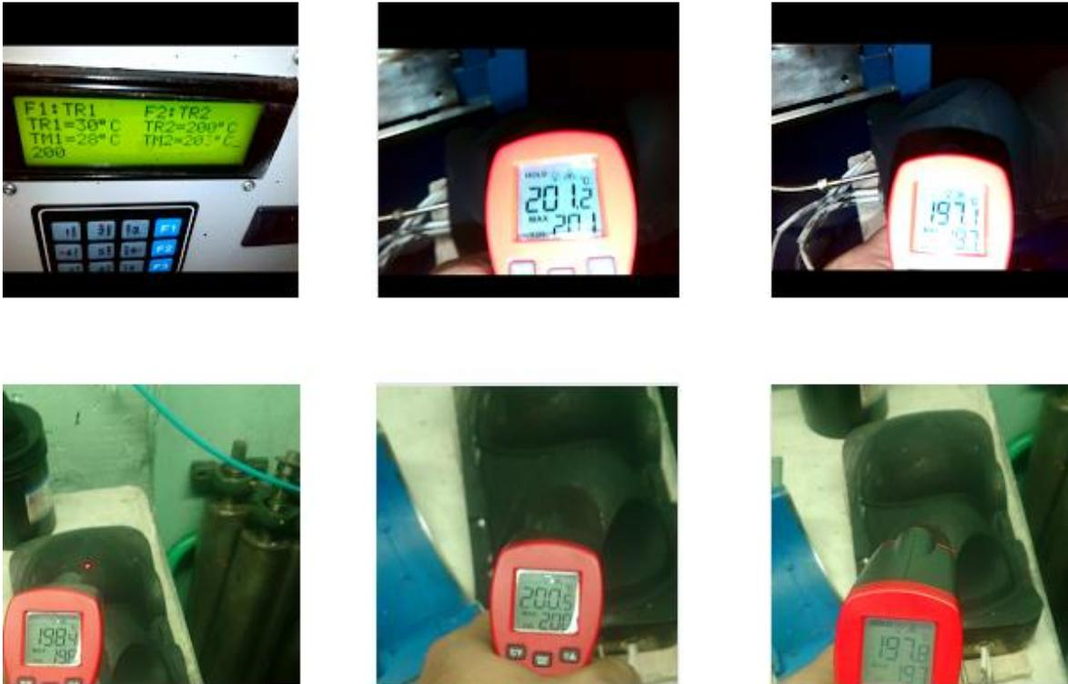
Figura 5.3: Pruebas de calentamiento con el control difuso. Fuente: Propia
