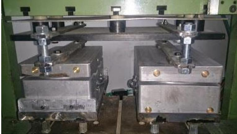
Figura 4.12: Moldes aislados de la estructura de la Prehormadora. Fuente: Propia
