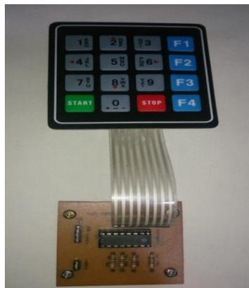
Figura 4.9: PCB real del teclado. Fuente: Propia
