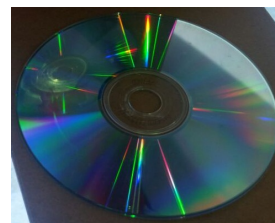
Figura 2.13: CD actuando como una red de difracción.
