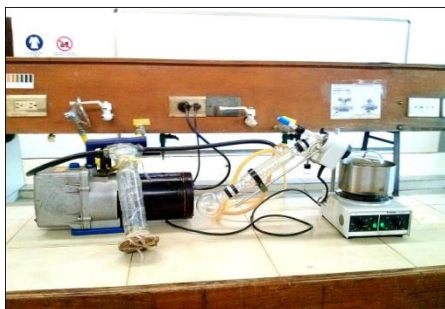
Figura 7. Obtención del Licopeno utilizando el rotavapor Fuente: El autor 2016
