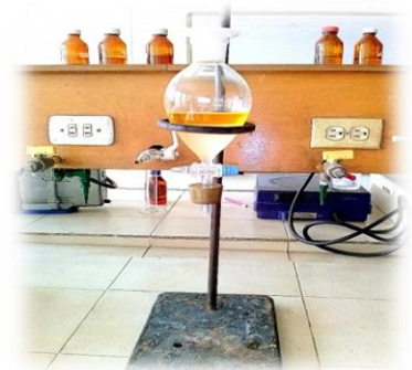
Figura 5. Separación de fases Fuente: el autor, 2016
