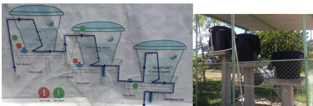
Figura 10. Prototipo de planta artesanal de potabilización de agua
