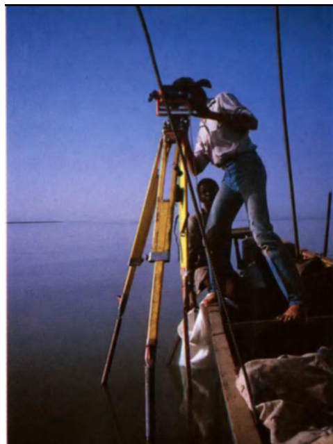
Imagen 46: Instalación de un punto geodésico sumergido
