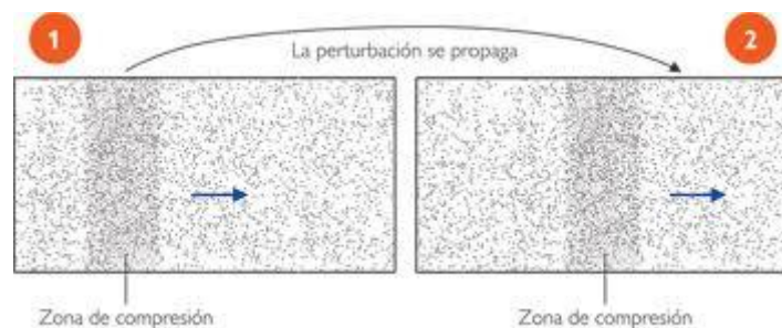
Figura 5: modelo de la propagación de un pulso a través de un gas. Tomada de http://co.kalipedia.com/ciencias-vida/tema/diapason.html?x1=20070924klpcnafyq_359.Kes&x=20070924klpcnafyq_367.Kes
