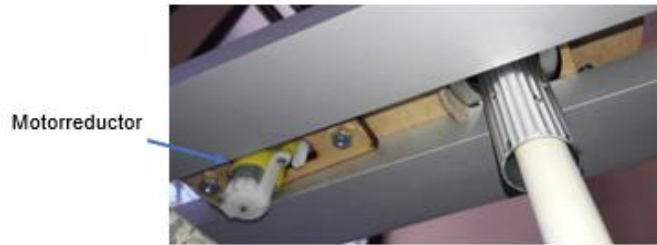
Figura 8 Componente mecánico, vista inferior.
