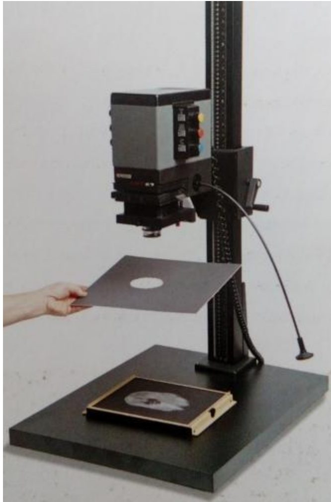
Figura XXXVII. Proceso utilizado para realizar una viñeta. Fuente: el laboratorio fotográfico guía practica del proceso de positivado y revelado (2003). (pg.70).
