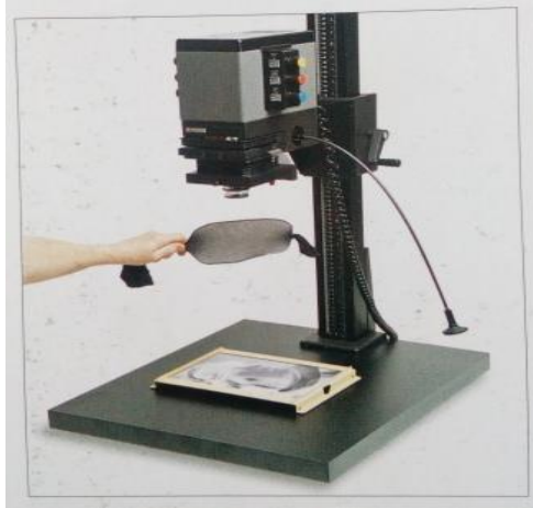
Figura XXXVIII. . Con la mano se sostiene la herramienta utilizada para realizar la técnica de difusión Fuente: el laboratorio fotográfico guía practica del proceso de positivado y revelado (2003). (pg.70).
