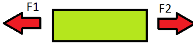
Figura 2. Esfuerzo a tracción. Representación gráfica del comportamiento de las fuerzas que actúan a tensión sobre un elemento. Elaboración propia.
