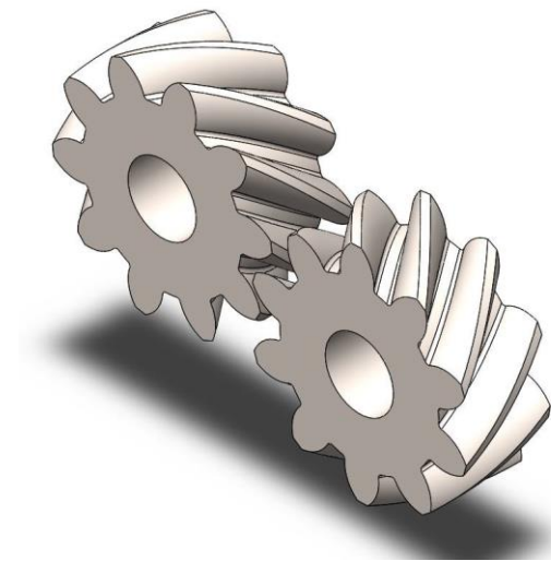
Figura 30. Engrane helicoidal. Representación gráfica de un engrane helicoidal. Basado en (Budynas R. y Nisbett J., 2008)
