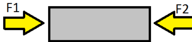
Figura 1. Esfuerzo a compresión. Representación gráfica del comportamiento de las fuerzas que actúan a compresión sobre un elemento. Elaboración propia.
