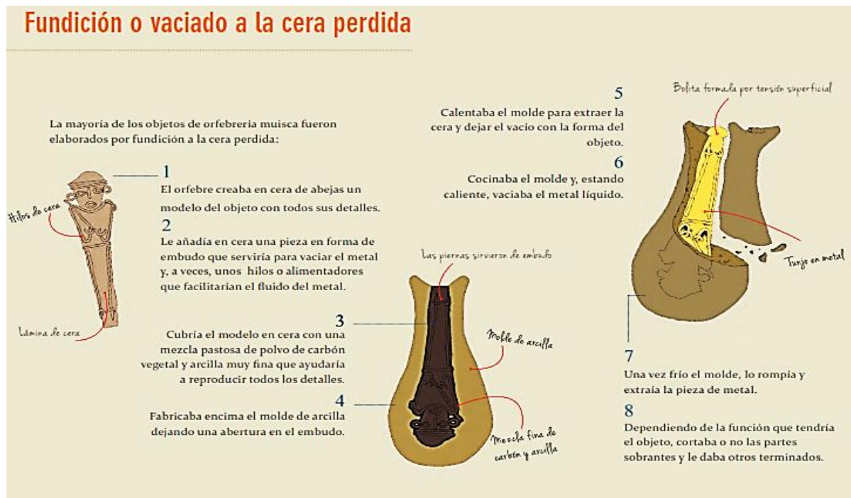
Figura 7. Proceso técnica Cera perdida. Tomado de Museo del Oro y UCL Institute of Archaeology, 2013
